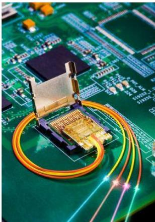
圖說：Thunderbolt 高速傳輸介面的前身為光纖應用方案的 Light Peak(開發代號)，Thunderbolt 選擇一個較低成本的銅纜與光纖線纜應用方案。(Intel)
