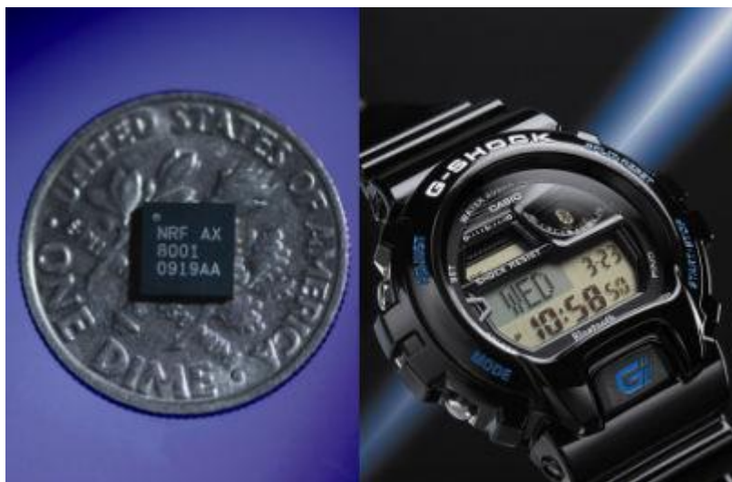
圖3：Nordic半導體的 \mu Blue nRF8001是該公司的藍牙低耗能晶片，Casio已經把它用於G-SHOCK低耗能手錶。
