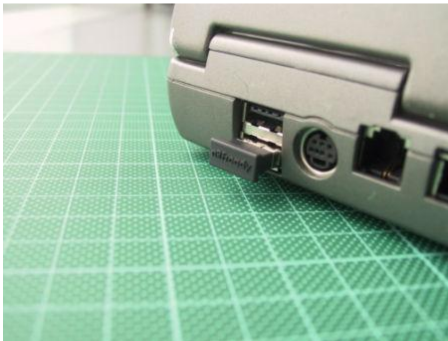
圖 1：利用 4LU1+個人電腦外設製造商可以製造尺寸很小的 USB 轉接器，它幾乎沒有伸出到主機 USB 口外面。
