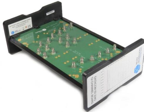
隨著我們達到更高的資料速率，C2M（晶片到模組）和 C2C（晶片到晶片）高速電氣介面的通道校準和壓力測試變得越來越重要。 Wilder Technologies 224G, 112 Gbaud PAM4, ISI – 符號間干擾損耗建範本提供高於和低於規格平均值的 10 通道擴展，最適合為 IEEE 802.3dj 通道測試添加通道壓力和信號校準。 無論是校準您的通道還是對 DUT 進行壓力測試，Wilder 的 Datacom 224G ISI 板都能滿足您的需求。
