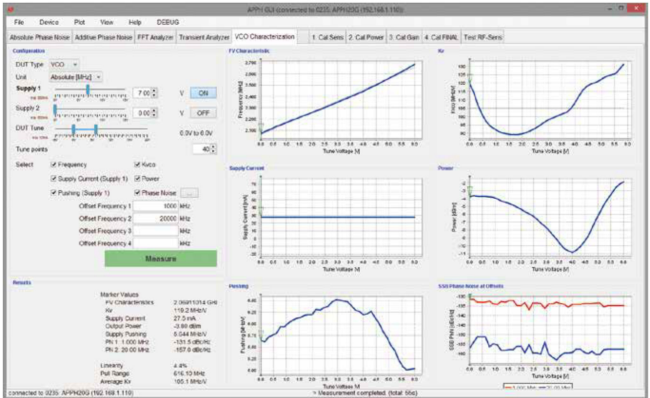
图3. 测试控制电脑显示的一个典型宽带 VCO 整体性能参数和曲线集。
