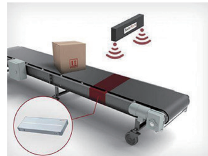
圖11. TeraSense line camera搭配輸送帶執行高速檢驗
